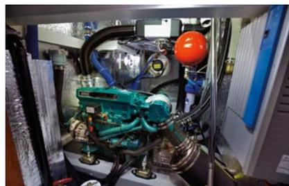
**Motorisierung:** Der 75 PS starke Volvo Penta-Dieselmotor ist mit 4 Dämpfern auf ein schweres Fundament montiert, um Vibrationen und Lärm möglichst gering zu halten. Die Starterbatterie wird nur vom Motor genutzt, für den übrigen Strombedarf an Bord stehen 4 Batterien (total 12 V, 480 Ah) zur Verfügung.
