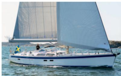
Einfaches Handling und sportliches Segeln – die HR 64 ist ein weiteres Meisterstück von Germán Frers. Das Rollgross mit senkrechten Latten hat einen erstaunlich guten Shape, die 100%-Genua sorgt für die richtige Düse. Die kleine (Sturm-)Fock auf dem optionalen Kutterstag ist bei Starkwind eine sinnvolle Besegelungsvariante, bei (zu) wenig Wind kommen der – ebenfalls optionale – Code-Zero oder ein Gennaker zum Einsatz.
