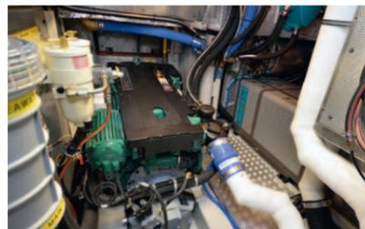
HR-Yachten haben traditionell einen starken Motor – das ist bei der HR 64 mit dem eingebauten Volvo Penta D6-280 nicht anders. Der 5,5-Liter-Motor verfügt über einige Kraftreserven. Schon bei 1500 Touren steigt die Geschwindigkeit auf über 7,5 Knoten, der Verbrauch beträgt 8,8 l/h. Mit dem 1800-l-Tank ergibt das eine Reichweite von über 1500 Seemeilen! Für Magnus Rassy ist klar: «Diesel muss immer genug an Bord sein.»
