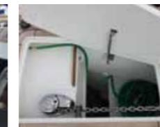
Il gavone dell'ancora ingoia 100 m di catena senza sforzo; il salpancore, però, non ha la campana di tonneggio
