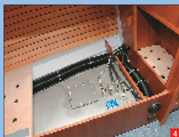
▲ El depósito de combustible, en acero inoxidable, se instala también bajo los asientos del salón.
